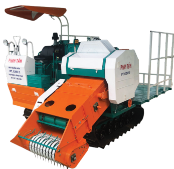
Hình 2. Máy cuốn rơm tự hành dùng bánh xích Phan Tấn PT-CR57
